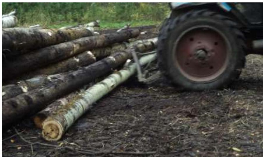
**Рис. 40 Трелевочный трактор производит штабелевку на погрузочном пункте путем сталкивания хлыстов навесным приспособлением трактора**
