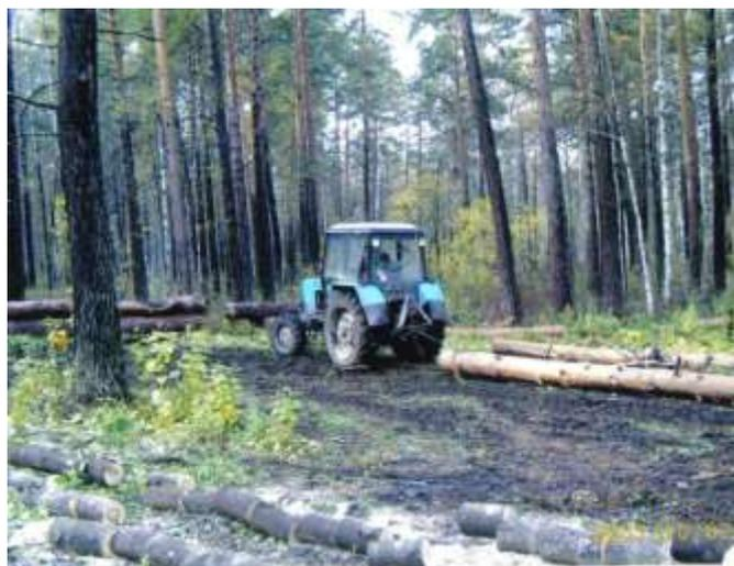
**Рис. 31** Сельскохозяйственный трактор МТЗ 82-1 в процессе трелевки сортиментов на погрузочном пункте
