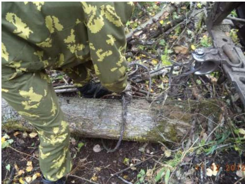
**Рис. 32** Чокеровщик производит зацепление ствола срубленного дерева за комель.
