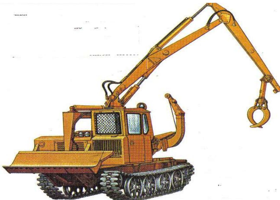
**Рис. 34** Трелевочный трактор с бесчокерным оборудованием ТБ-1.
